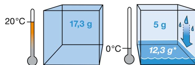
Wassergehalt der Luft/m³ bei unterschiedlichen Raumtemperaturen
